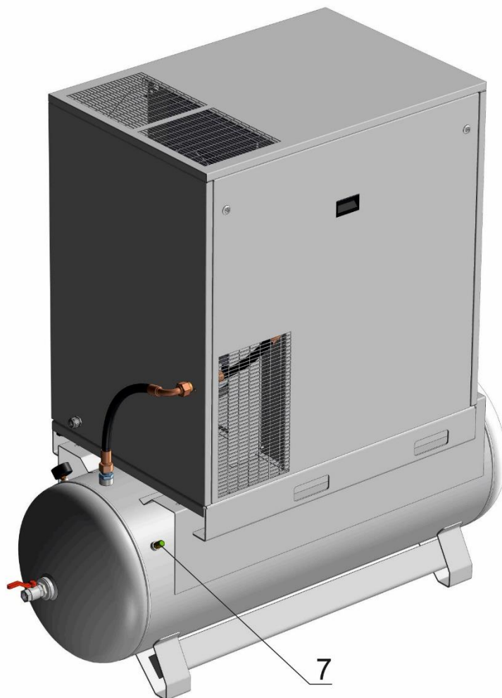
Рисунок 2 – Общий вид компрессорных установок ВК25-...-500(BC), 30-...-500(BC)
